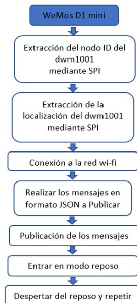
Fig. 10. Esquema de funcionamiento del WeMos D1 mini.
