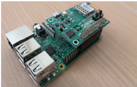
Fig. 4. Gateway conformado por DWM1001-dev y Raspberry Pi 3B+.
