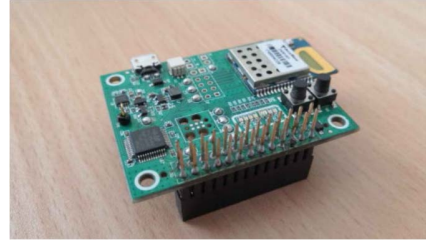
Fig. 5. Módulo DWM1001-dev de Decawave.
