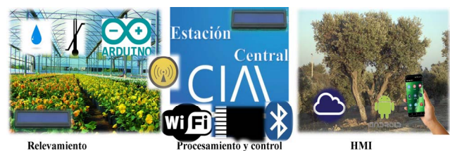
Fig. 1. Planteo esquemático simplificado de forma general. El desarrollo práctico posee tres partes principales: adquisición, transmisión, e interfaz con el usuario, de las variables de interés para la producción de cualquier cultivo en invernaderos o campo abierto.
