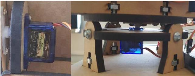
Fig. 2. Servo-motores para controle de posição do PV.
