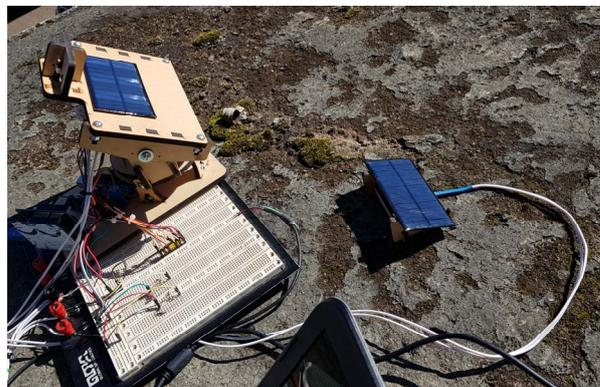
Fig. 1. Protótipo do seguidor solar em utilização.
