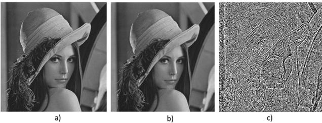
Fig. 7. Respuesta de los filtros: a) Original, b) Promedio y c) Laplaciano-Gaussiano.
