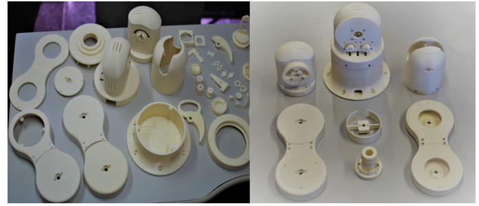
Fig. 8. Peças impressas e montagens parciais das articulações.
