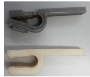
Fig. 6. Resultado de ensaio realizado com peças impressas em plástico PLA (acima) e plástico ABS (abaixo) a partir de inserção de parafuso [20].
