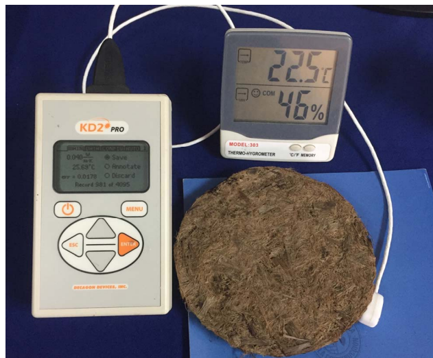
Figura 4. Medición de conductividad térmica a prototipo.
