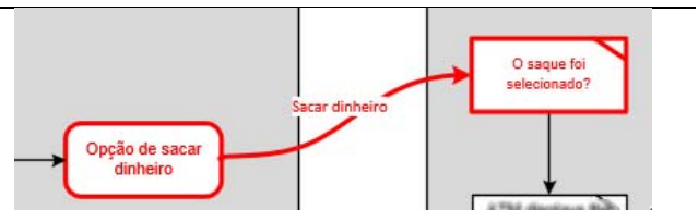
Fig. 11. Apresentação de um pequeno fragmento do algoritmo de verificação e a respectiva visualização gráfica destacada de incompatibilidade encontrada.
