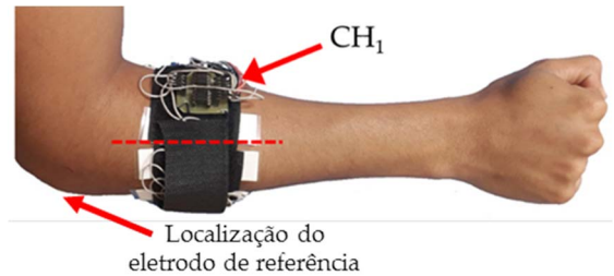
Fig. 1. Ilustração do posicionamento da armband de oito canais, instalada no antebraço, contendo a indicação do primeiro canal (CH 1 ), localizado no músculo do flexor do carpo ulnar.
