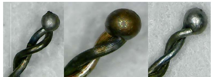
Figura 11. Termopar tipo E bitola 32 AWG (esq); Termopar tipo T bitola 26 AWG (centro); Termopar tipo K bitola 32 AWG (dir).
