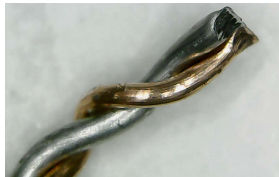
Fig. 6. Par metálico termopar tipo T antes da soldagem.
