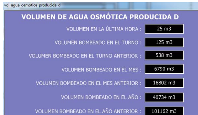
Fig. 12. Pantalla donde se muestra el volumen bombeado de la planta.
