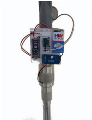
Fig. 6. Placa de Circuito Impresso com os componentes em seu local de fixação na parte superior da muleta, próximo ao punho.
