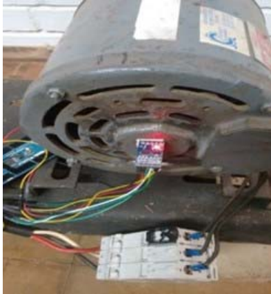
Fig. 3. Esquema de montagem do acelerômetro no motor de indução.
