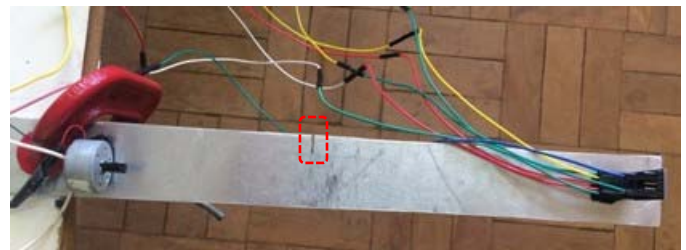
Fig. 2. Setup do experimento de uma viga engastada com falha. O retângulo tracejado em vermelho indica a falha.
