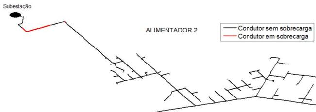
Fig. 15. Condutores em sobrecarga no alimentador #2 – caso base – sem GDs.
