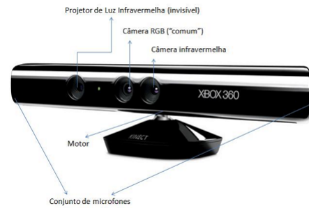
Fig. 2. Arquitetura básica do Kinect [13].
