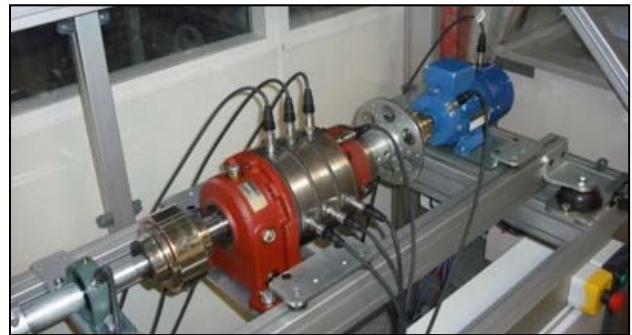
Fig. 11. Distribución de los acelerómetros en el prototipo.
