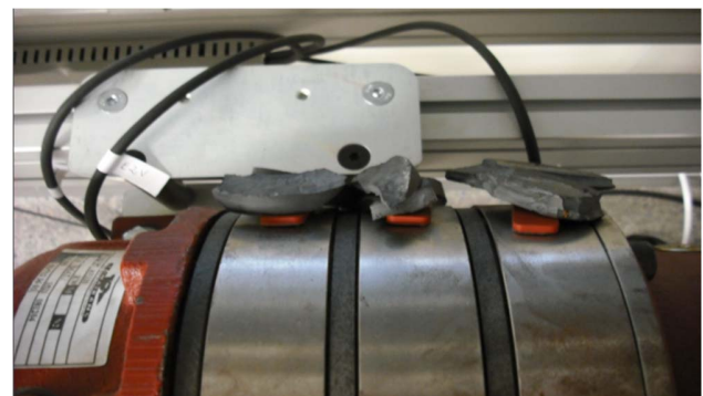
Fig. 5. Distribución de los sensores de temperatura sobre la multiplicadora.
