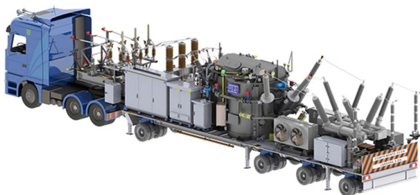
Fig. 1. Subestação de distribuição móvel, instalada sobre a carroceria de um caminhão – Fonte :WEG Transformadores.
