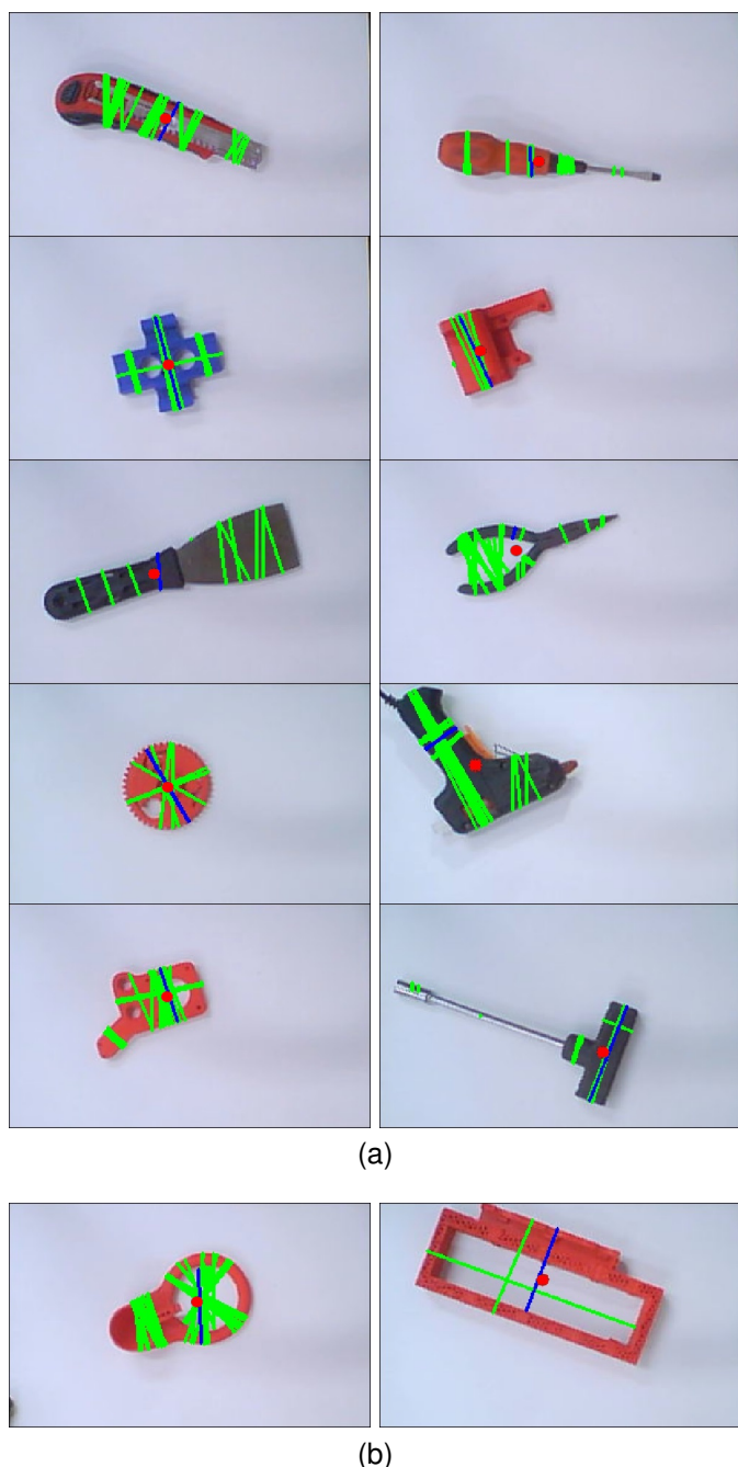
Fig. 7. Resultados de pruebas de agarre: a) Posiciones de agarre exitosas estimadas por el algoritmo, b) Ejemplo de agarre de fallas.
