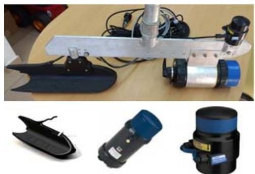
Fig. 2. Sensores acústicos montados en la quilla (arriba) consistentes en: SONAR de barrido lateral StarFish, ecosonda Super SeaKing y SONAR de barrido frontal Micron, equipos de la firma Trittech® (abajo, de izquierda a derecha).
