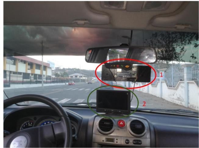
Fig. 7. Prototipo del sistema de detección de peatones instalado en la plataforma experimental **ViiA**, en (1) se encuentra la cámara y la tarjeta de procesamiento, en (2) se tiene la pantalla de visualización.
