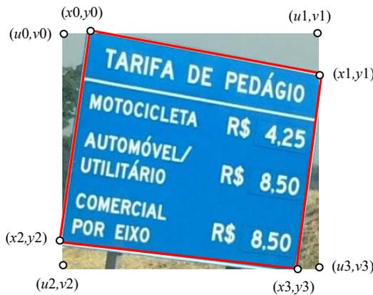
Fig. 6. Coordenadas  $(x, y)$  e  $(u, v)$  da placa.
