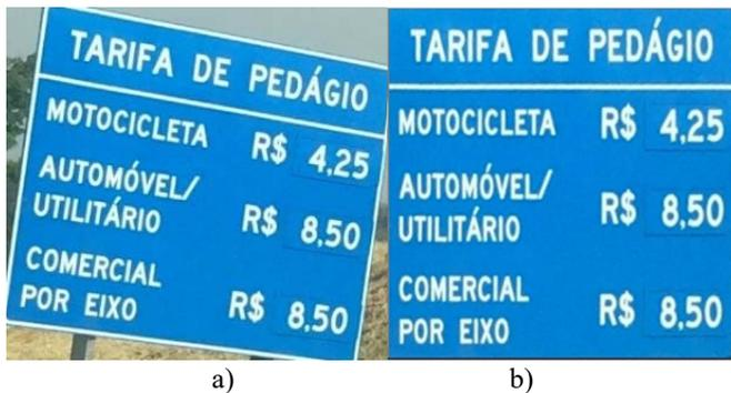
Fig. 7. Correção de perspectiva. a) Placa deformada. b) Placa com a perspectiva corrigida.
