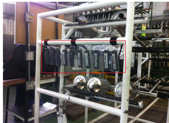
Fig. 6. Etiquetas RF620T reutilizables ubicadas en los transportadores de piezas y señaladas por el rectángulo rojo.
