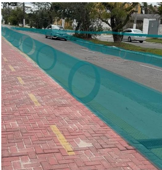
Fig. 7. Projeção de modelos 3D georreferenciados através da interface móvel. A imagem demonstra a transparência e o posicionamento das tubulações em relação à via pública, validando a integração entre modelagem hidráulica e RA.
