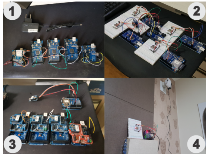
Fig. 4. A primeira imagem demonstra o teste com módulos Sub-GHz, a segunda com WiFi, a terceira com ZigBee e a quarta um nodo WiFi durante o experimento.
